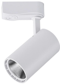
型號 MODEL NO. : TKL-1201-7W-W 電壓 VOLT: 85-260V 功率 WATT: 7W 光束角度 BEAM ANGLE: 38° 光源色溫 COLOR TEMP.: 3000K / 6000K 演色指數 CRI: 80 外觀顏色 APPEARANCE COLOR : 白色 WHITE 尺寸 SIZE(MM): Ø60x100, H158xW90
