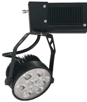
型號 MODEL NO. : TKL-1120 電壓 VOLT: 85-265V 功率 WATT: 12W (9 珠) 光源色溫 COLOR TEMP.: 3000K / 4000K / 6000K 發光角度 BEAM ANGLE: 30° 外觀顏色 APPEARANCE COLOR : 黑色 BLACK
