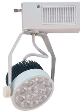
型號 MODEL NO. : TKL-1121 電壓 VOLT: 85-265V 功率 WATT: 15W (12 珠) 光源色溫 COLOR TEMP.: 3000K / 4000K / 6000K 發光角度 BEAM ANGLE: 30° 外觀顏色 APPEARANCE COLOR : 白色 WHITE
