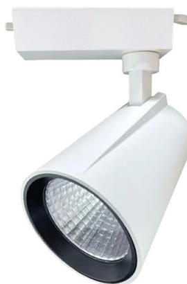
型號 MODEL NO. : TKL-1207-20W-W 電壓 VOLT: 85-260V 功率 WATT: 20W 光束角度 BEAM ANGLE: 38° 光源色溫 COLOR TEMP.: 3000K / 4000K / 6000K 演色指數 CRI: 80 外觀顏色 APPEARANCE COLOR : 白色 WHITE 尺寸 SIZE(MM): Ø90 x W135 x H140
