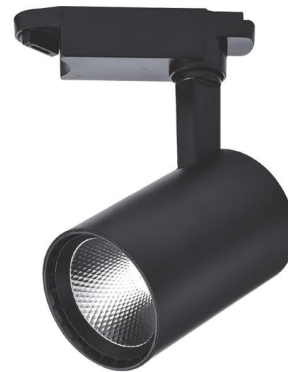
型號 MODEL NO. : TKL-1204-12W-B 電壓 VOLT: 85-260V 功率 WATT: 12W 光束角度 BEAM ANGLE: 38° 光源色溫 COLOR TEMP.: 3000K / 6000K 演色指數 CRI: 80 外觀顏色 APPEARANCE COLOR : 黑色 BLACK 尺寸 SIZE(MM): Ø80x120, H210xW140
