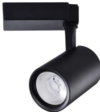
型號 MODEL NO. : TKL-1210-30W-B 電壓 VOLT: 85-260V 功率 WATT: 30W 光束角度 BEAM ANGLE: 38° 光源色溫 COLOR TEMP.: 3000K / 6000K 演色指數 CRI: 80 外觀顏色 APPEARANCE COLOR : 黑色 BLACK 尺寸 SIZE(MM): Ø90x140, H250xW176
